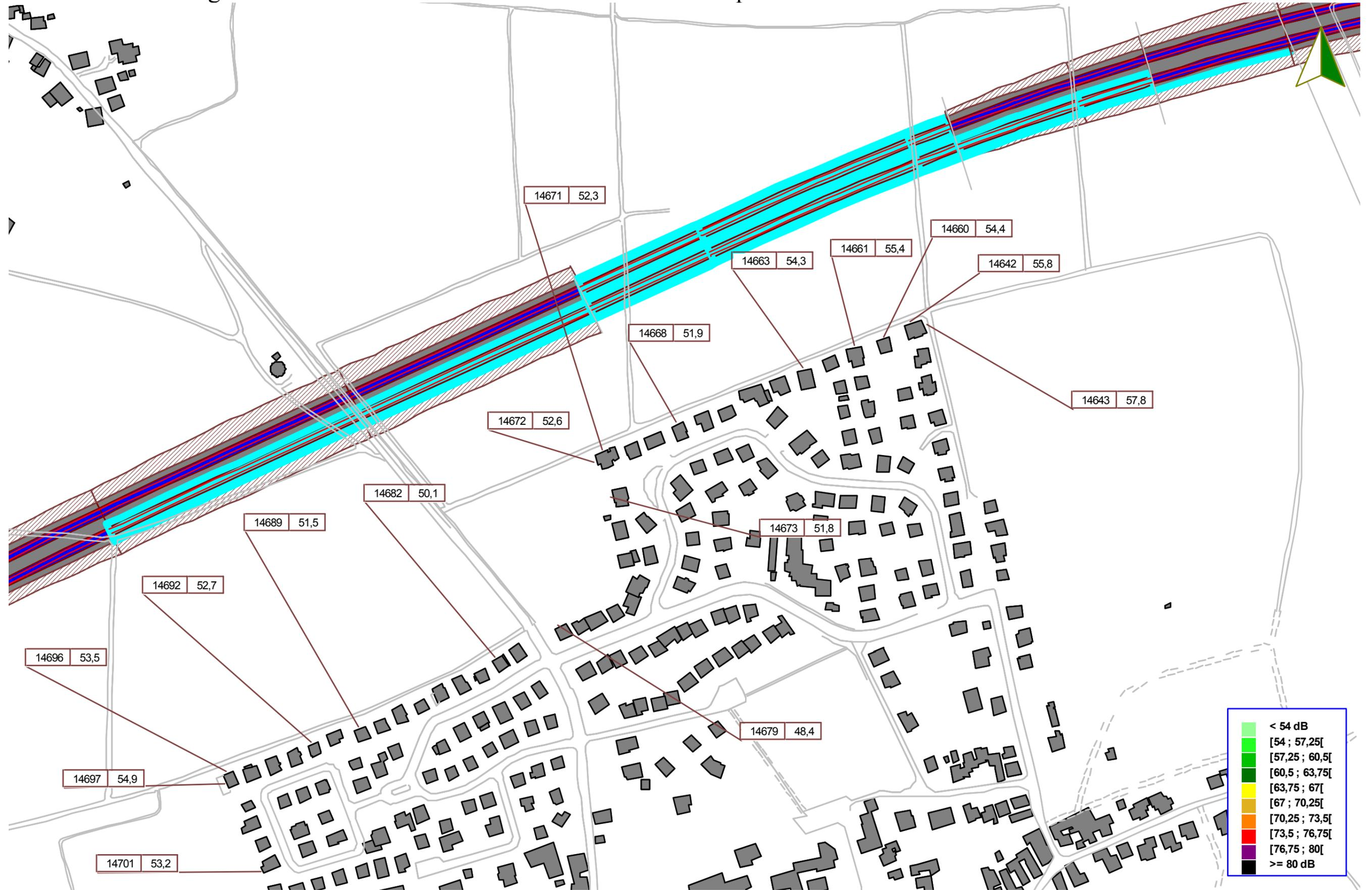
Solution B Remplacement des 200m les plus à l'ouest de la tranchée par une semi couverture, décalage vers l'est de la tranchée couverte et sa prolongation sur 100m à l'est par une semi-couverture et des écrans à l'est
